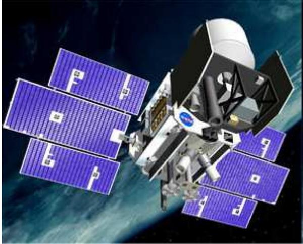
GLAS (the Geoscience Laser Altimeter System) conçu par la NASA a été le premier lidar développé pour effectuer des observations continues en orbite terrestre en visant une durée de vie de 5 ans (redondance de 3 sources laser « tout solide »).
