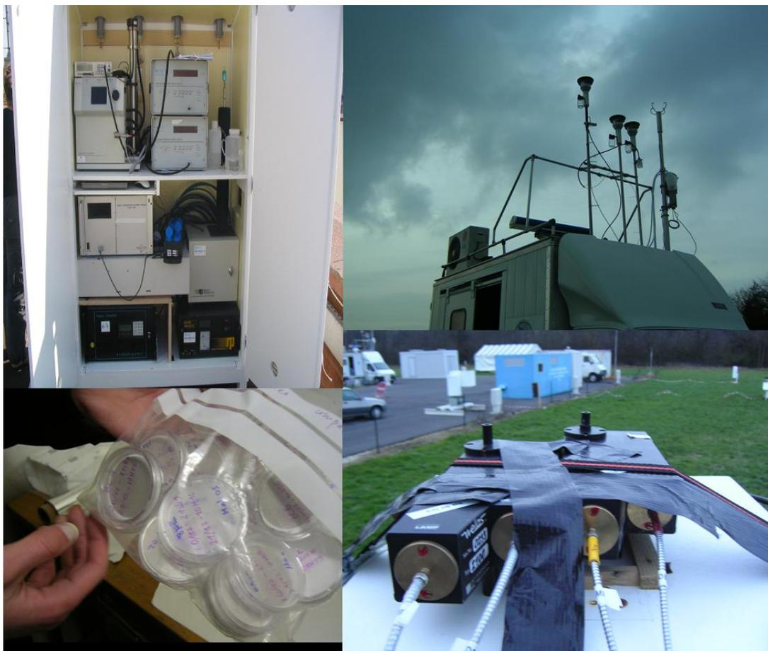
FIG. 3.3 – Instruments microphysiques lors de la campagne de mesures ParisFOG. A haut à gauche, l'armoire contenant le SMPS et l'OPC (Pallas welas 2000). A haut à droite, les têtes de prélèvements sur filtres. En bas à gauche, des exemples de filtres pour le carbone organique et le black carbon. En bas à droite, les têtes de prélèvement des granulomètres OPC (Pallas welas 2000).
