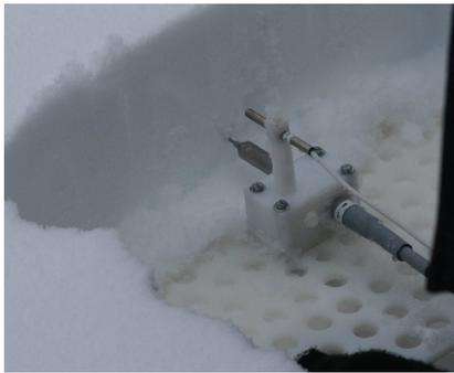
**Figure 1** – Insertion des sondes dans la neige au col de Porte (Chartreuse, 1310m alt.)
