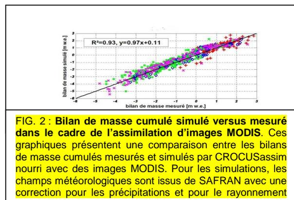
**FIG. 2 : Bilan de masse cumulé simulé versus mesuré dans le cadre de l'assimilation d'images MODIS. Ces graphiques présentent une comparaison entre les bilans de masse cumulés mesurés et simulés par CROCUSassim nourri avec des images MODIS. Pour les simulations, les champs météorologiques sont issus de SAFRAN avec une correction pour les précipitations et pour le rayonnement**
