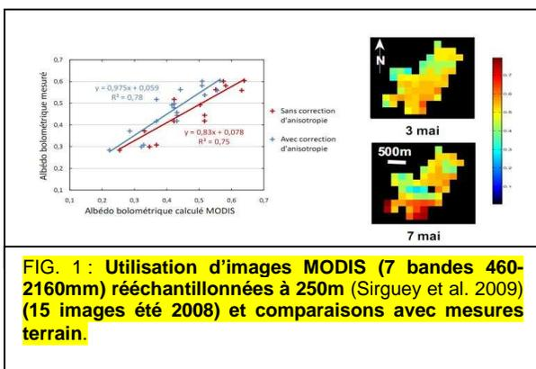
**FIG. 1 : Utilisation d'images MODIS (7 bandes 460-2160nm) rééchantillonnées à 250m (Sirguey et al. 2009) (15 images été 2008) et comparaisons avec mesures terrain.**
