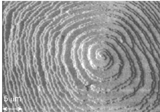
FIG. 14 – Croissance en spirale autour d'une dislocation vis (image AFM d'un cristal de canavaline, une macromolécule, d'après Land et. al. , Surf. Sci. , 1997).
